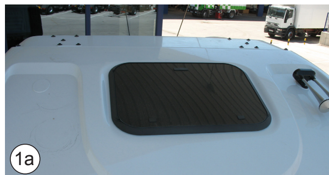
Kabina Stralis sprzed roku 2008: Uszczelka EPDM 40 x 40
