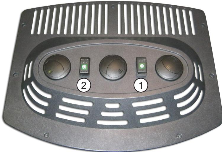
1. Interruttore On/Off. 1<sup>a</sup> velocità del ventilatore.
