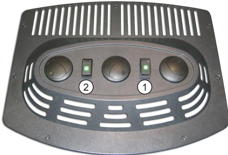
1. Interruptor On/off. 1<sup>a</sup> velocidad del soplador.
