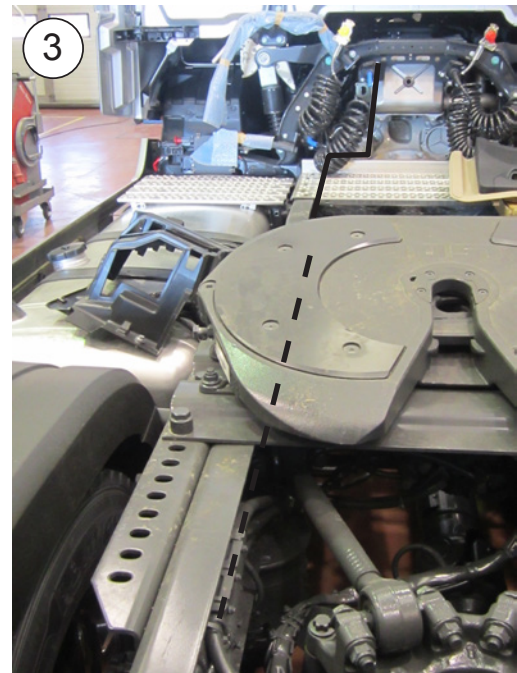
Mitgelieferte 30A Sicherung anbringen und mit Unterlegscheibe und Mutter befestigen.
