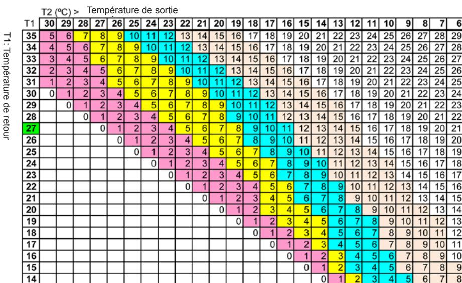
Différence de température entre l'air à l'entrée de l'aspiration et la sortie de l'air par les vitres.
