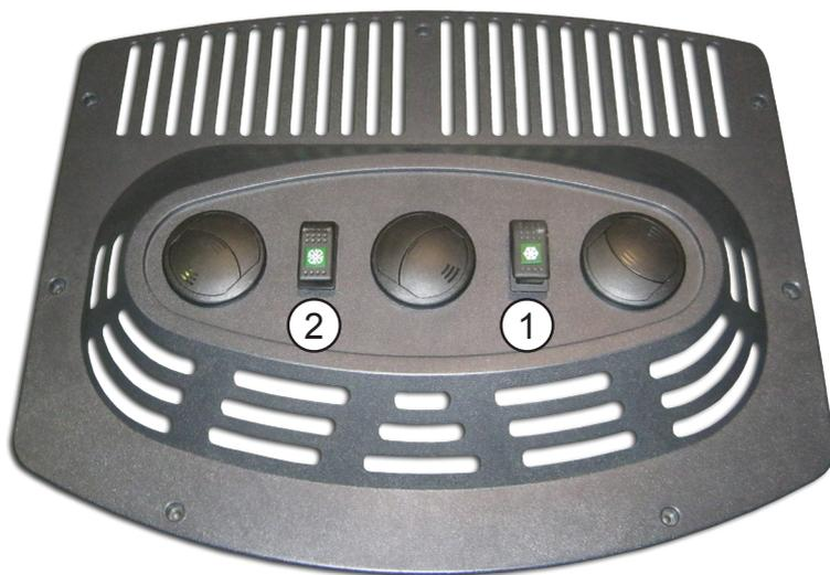
1. Interruttore **On/Off**. 1<sup>a</sup> velocità del ventilatore.
